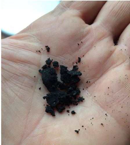
2g Rost- und Magnetitablagerungen aus einer 2L Heizwasserprobe eines 3 Jahre alten Hauses
